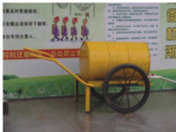
移动式洒水车：采用钢管、角钢及废弃油桶组装而成。外观轻巧、结构简易、移动使用方便。
